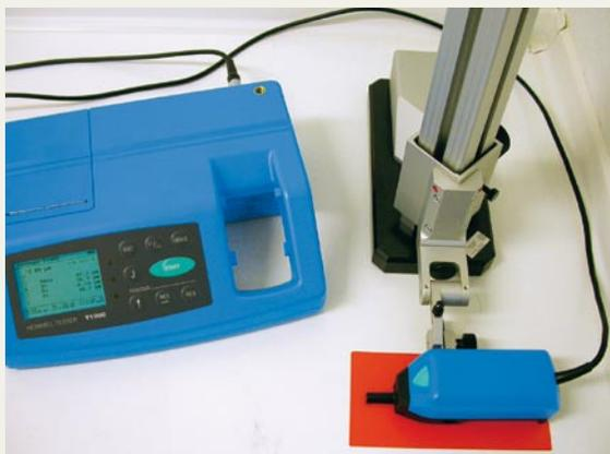
Bild 3: Messeinrichtung zur Bestimmung der Rauigkeitsprofile von Strukturpulverlack-Oberflächen
