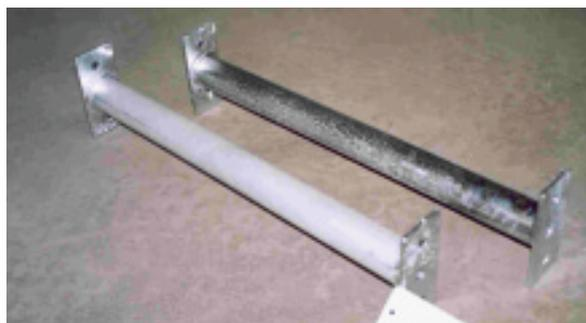
Matte und dicke Zinküberzüge neigen zum starken Ausgasen bei der Pulverlackierung
