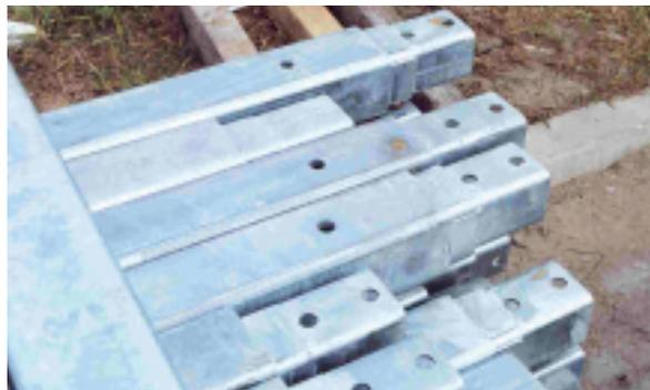
Wird der Zinküberzug durchgeschliffen, ist unbedingt eine partielle Grundierung vor der Pulverbeschichtung erforderlich
