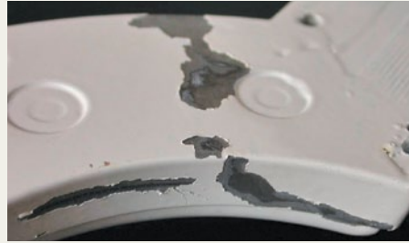
Bild 8: Überbeizte Türverzierungen aus Aluminium-Druckguss bei Mischfahrweise
