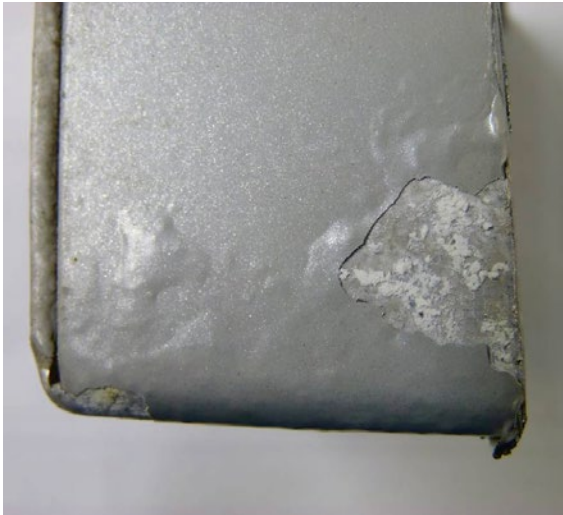
Bild 1 > Fehlerbeispiel 1: Hier wurden die Beanspruchungsbedingungen einer Aluminiumfassade an einer Fernverkehrsstraße nicht berücksichtigt.
