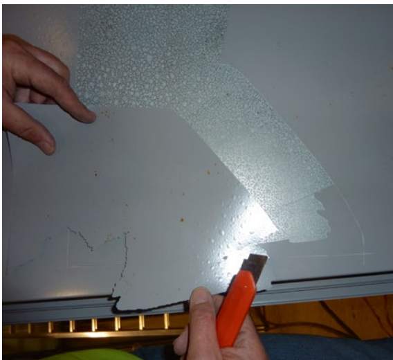
Bild 2 > Fehlerbeispiel 2: Staub- und Nasslackschadung an mit Nasslack beschichteten Feuerschutztüren in einem Atomkraftwerk.
