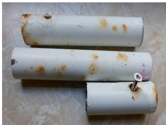
Bild 3 > Fehlerbeispiel 3: Pulverlackierung von Stahlrohren ohne Zinküberzug bei starker Korrosionsbeanspruchung.
