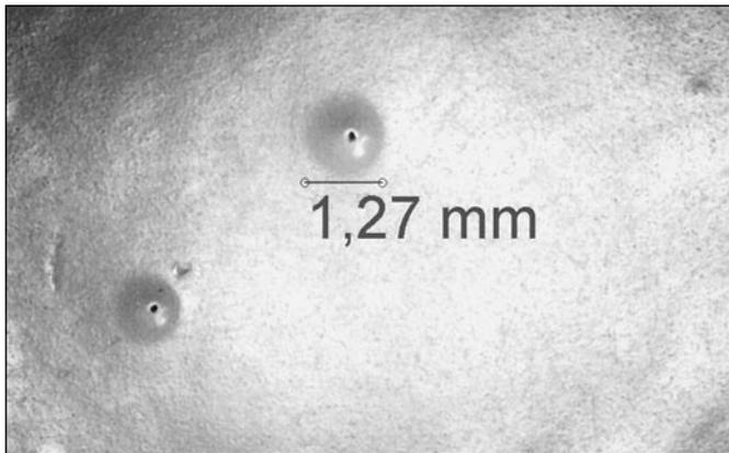
**Aufgrund von Ausgasungen des Zinküberzugs weist die pulverlackierte Stahlkonstruktion starke Blasen- und Kraterbildungen auf.**
