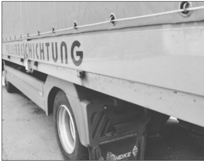
Werden Pulverlackierungen vorgenommen, die den Beanspruchungsbedingungen nicht gerecht werden, versagt die Beschichtung. Im Bild ein Transporter nach weniger als zwei Jahren Nutzungsdauer.
