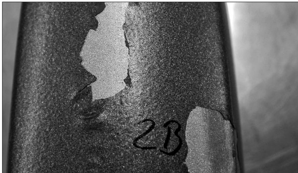
**Dieser Pulverlack auf einem Teil aus Aluminiumdruckguss ist nach Beanspruchung im neutralen Salzsprühnebeltest (480 h nach ISO 9227) abgeplatzt. Die Ursache liegt in der ungenügenden Beizentfettung mit nachfolgender chromfreier Passivierung.**
