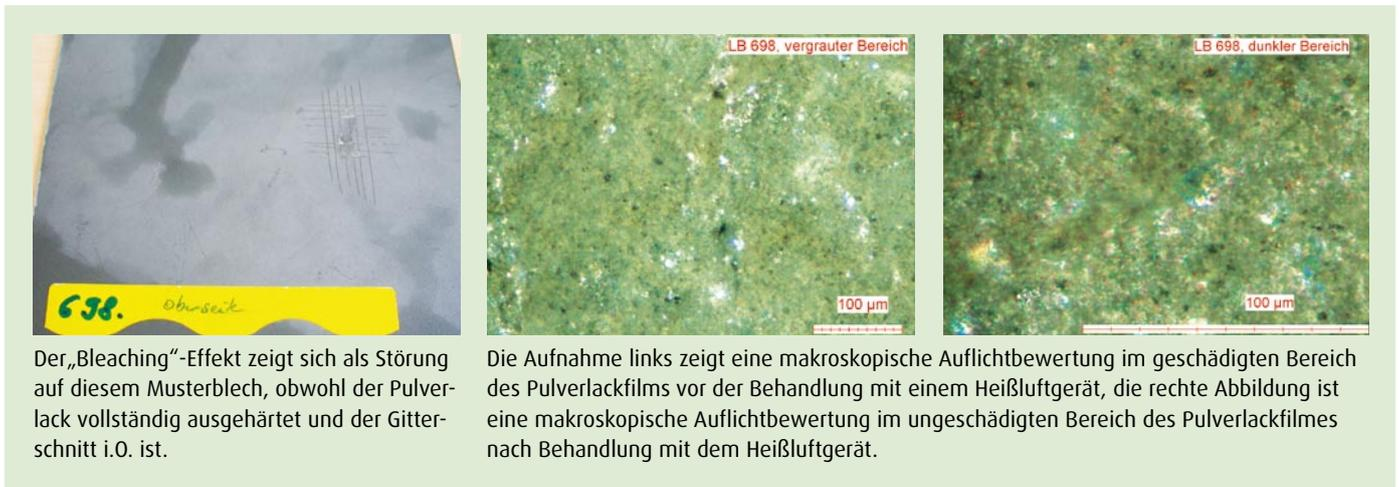
Der „Bleaching“-Effekt zeigt sich als Störung auf diesem Musterblech, obwohl der Pulverlack vollständig ausgehärtet und der Gitterschnitt i.O. ist.
