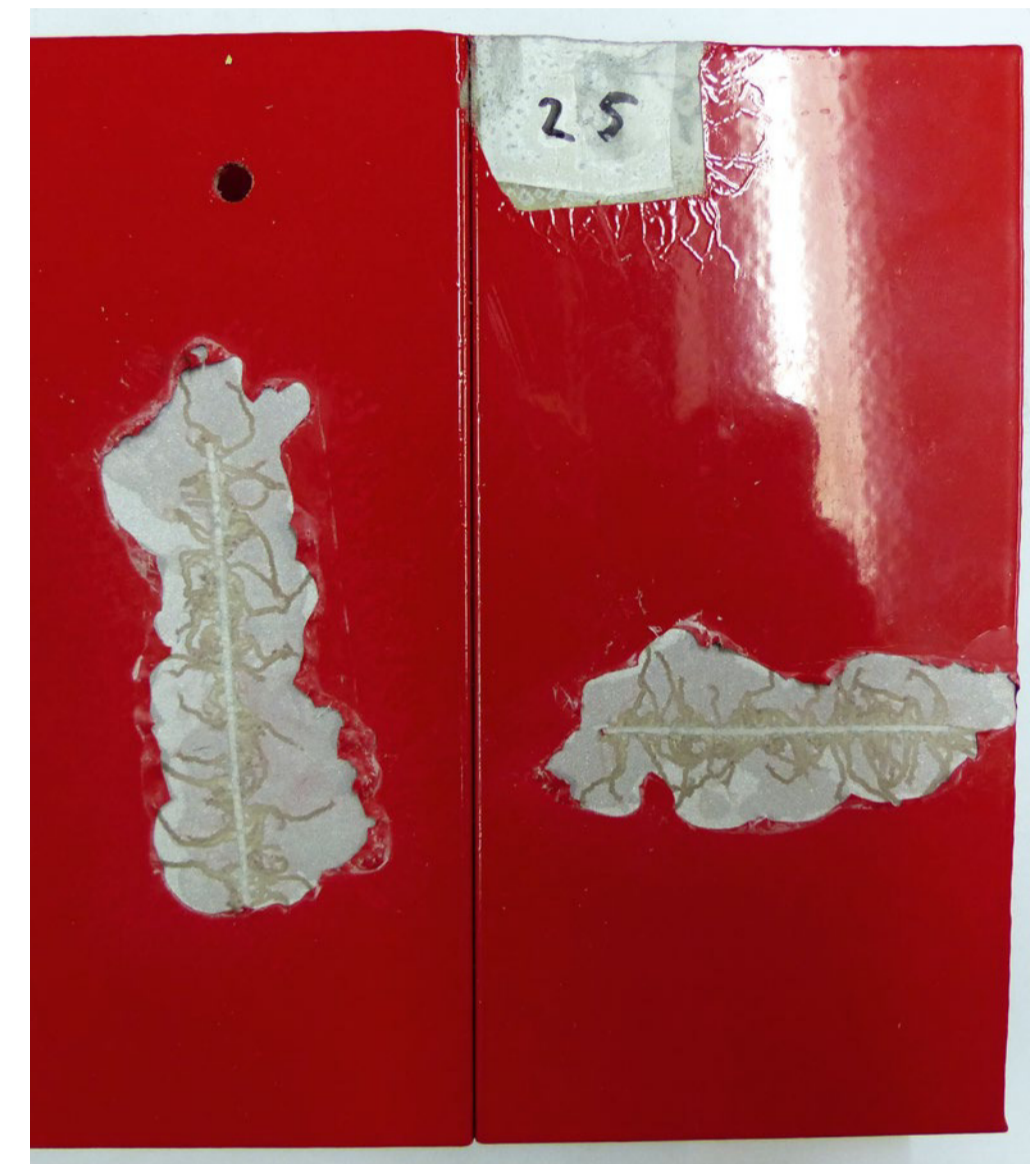
Zur besseren Bewertung und Vermessung der Filiformkorrosionsfäden ist das Bauteil für die Untersuchung im Labor partiell entlackt worden.
