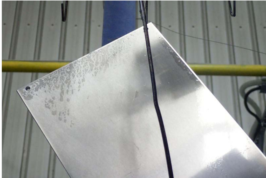
Fettreste nach der nasschemischen Oberflächenvorbehandlung auf der zu beschichtenden Stahloberfläche bedingt durch hohe Ausgangsverfettung und ungenügender Badpflege an einer Durchlaufanlage mit nur einem Aktivbad sowie nachfolgender Chromfrei-Passivierung.
