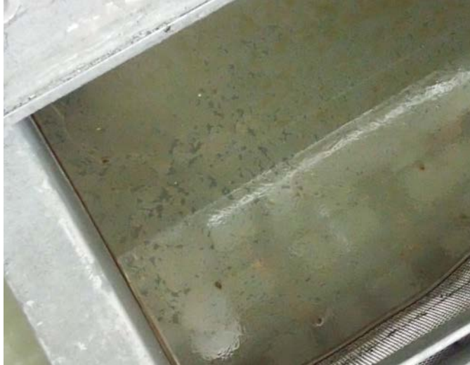
Das Entfettungsbad weist einen aufschwimmendem Ölfilm auf, ein Öl-Abscheider fehlt.
