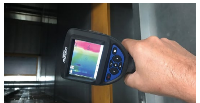
Das Wärmebild zeigt Kältebrücken an, d.h. zu niedrige Temperaturen im unteren Bereich des Ofenausgangs.
