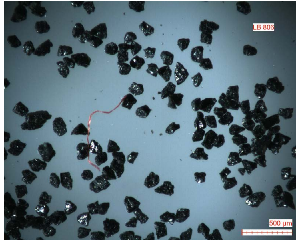
Mit einer Siebanalyse haben die Labormitarbeiter den Pulverlack auf fremdartige Partikel untersucht und eine Faser entdeckt.
