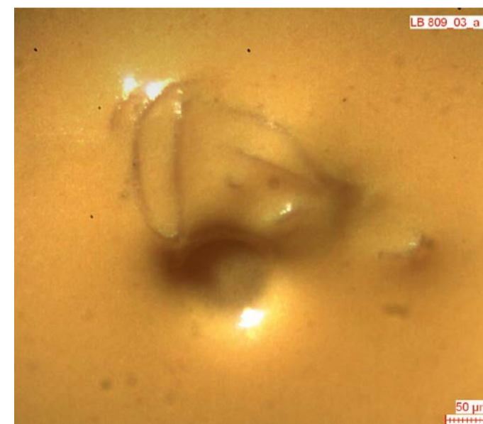
Die makroskopische Aufnahme einer Oberflächenstörung: Ursache ist ein Metallspan im thermochemisch vernetzten Pulverlackfilm.
