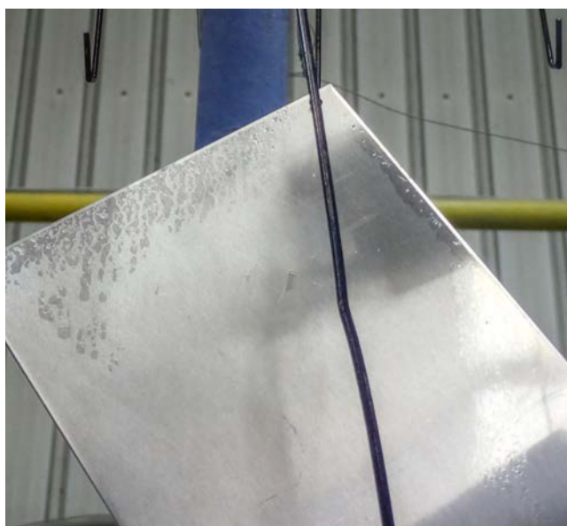
Fehlerursachen liegen sehr häufig in der Vorbehandlung: Hier sind beispielhaft Fettreste nach der nasschemischen Oberflächenvorbehandlung auf der zu beschichtenden Stahloberfläche zu erkennen. Die Ursachen liegen in einer hohen Ausgangsverfettung und ungenügender Badpflege in einer Durchlaufanlage.
